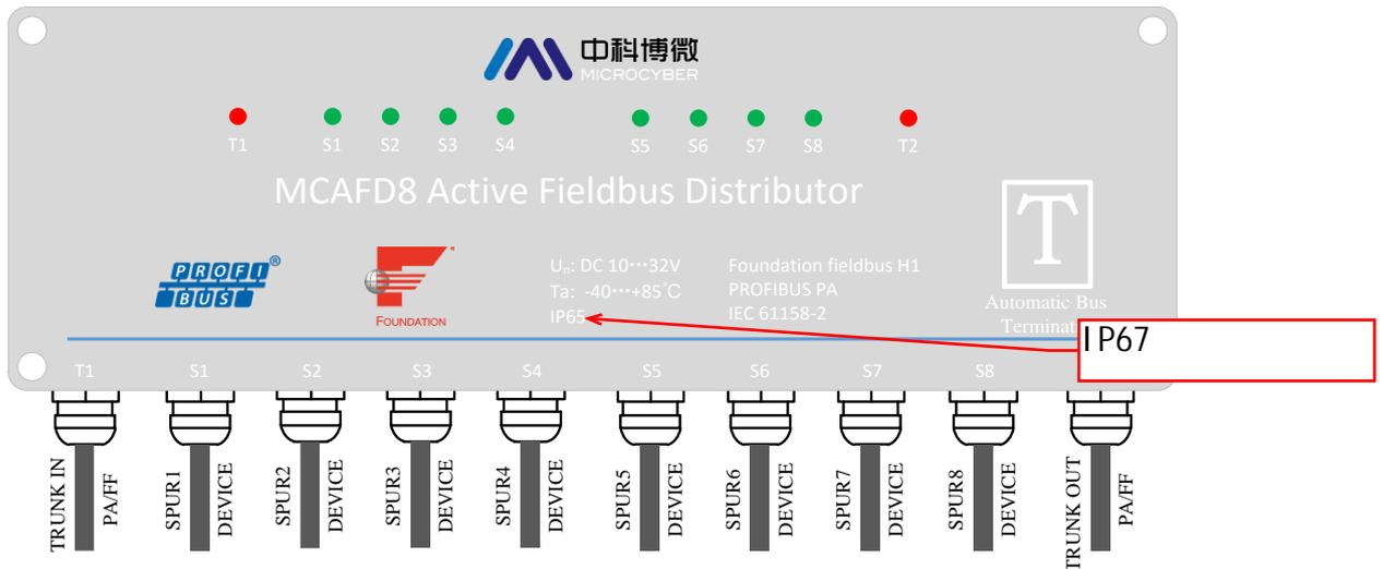
1. 通过 T1、T2 连接主线，T1 为总线输入，T2 为总线输出，通过支线 S1 到 S8 连接现场总线设备。
