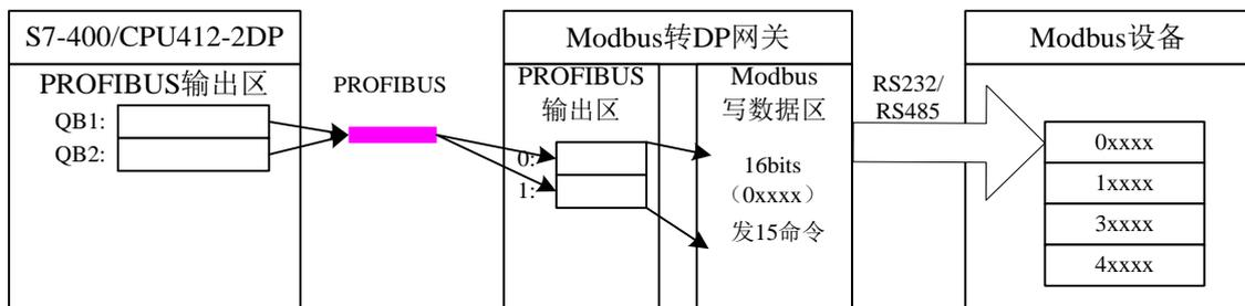
图 24 PROFIBUS 地址与 Modbus 地址对应关系
