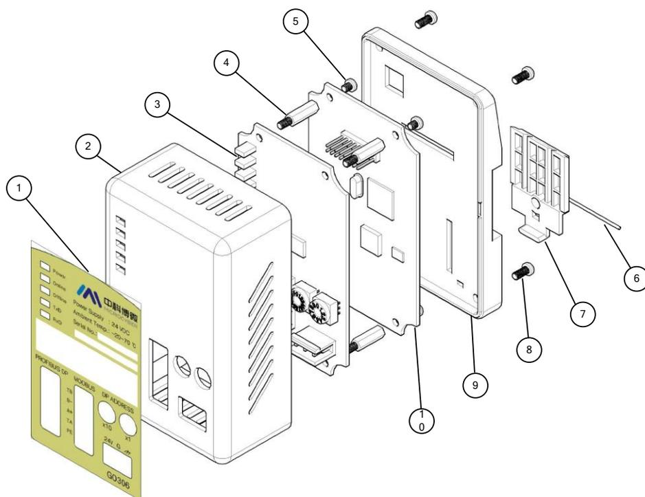
图3 网关结构图
