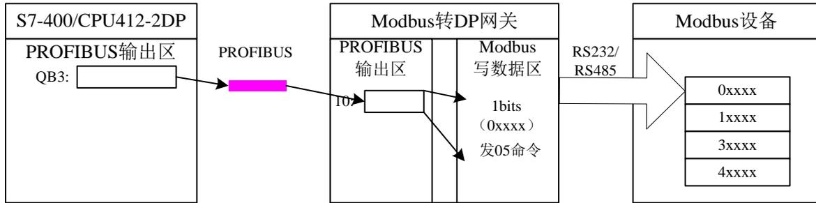
图 30 PROFIBUS 地址与 Modbus 地址对应关系
