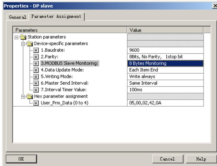
图 37 配置“3.MODBUS Slave Monitoring”设备用户参数
