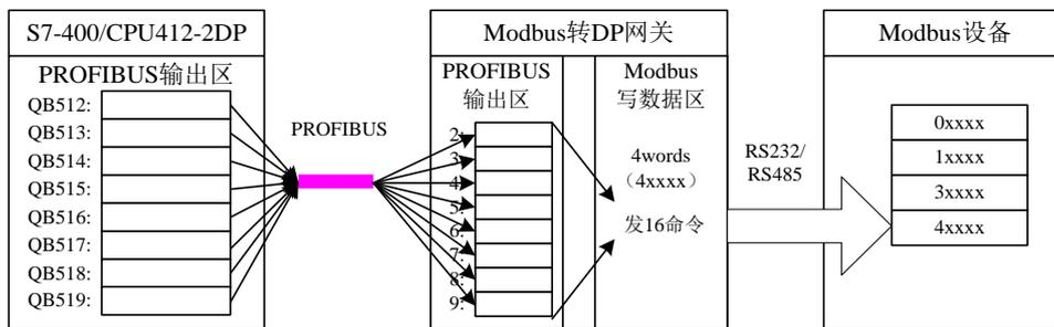
图 27 PROFIBUS 地址与 Modbus 地址对应关系
