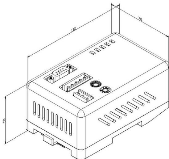
图2 网关外形尺寸图（112\*70\*50，单位 mm）
