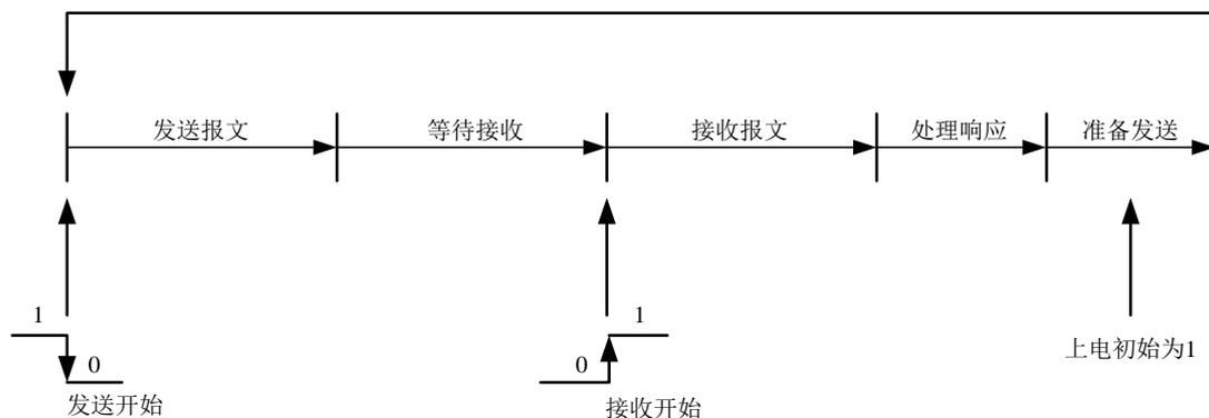
图 15 发送接收状态转换图
