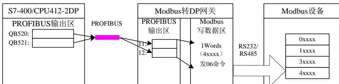
图 33 PROFIBUS 地址与 Modbus 地址对应关系
