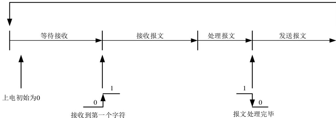
图 41 发送接收状态转换图
