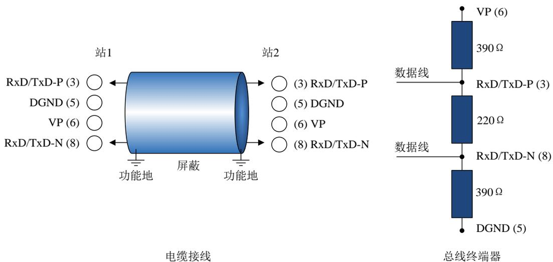
图 8 RS485 传输技术的布线和总线终端器
