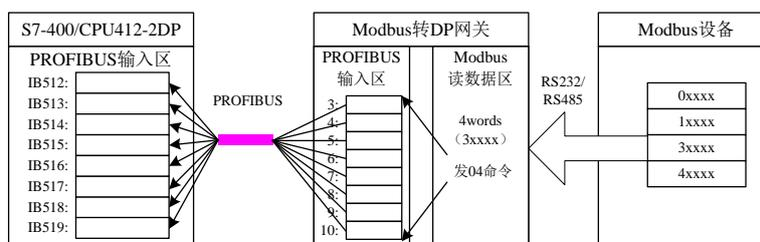
图 21 PROFIBUS 地址与 Modbus 地址对应关系
