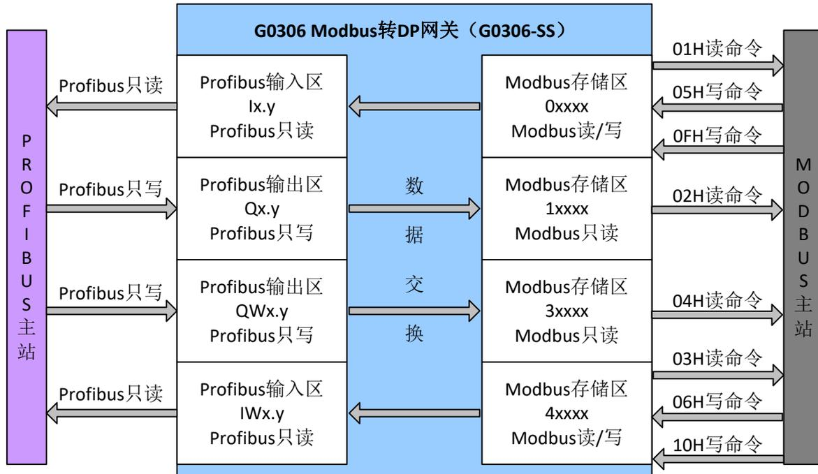
图 7 网关原理框图 (G0306-SS)
