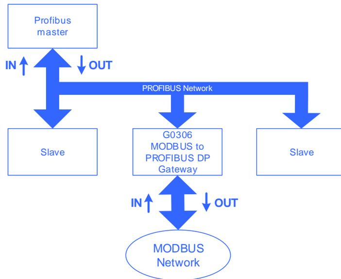
图 5 网关系统连接示意图
