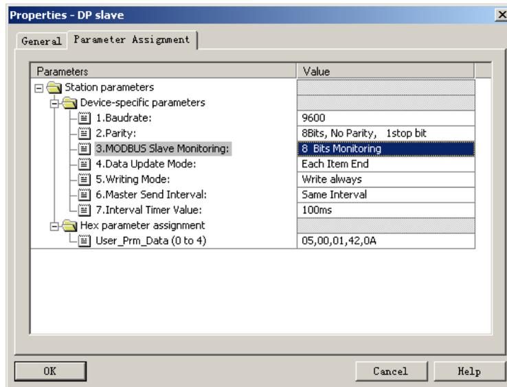
图 34 配置“3.MODBUS Slave Monitoring”设备用户参数
