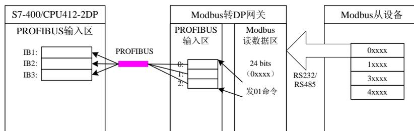
图 18 PROFIBUS 地址与 Modbus 地址对应关系
