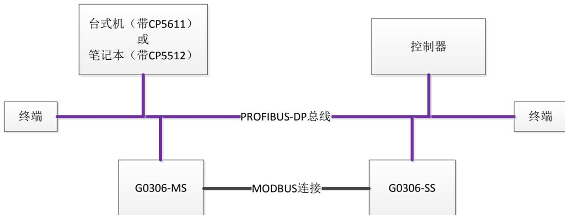
如上图所示，电脑、控制器以及两种工作模式下的 G0306 网关通过 90 度无编程 DP 连接器制作的 DP 总线连接起来，同时 G0306-MS 与 G0306-SS 之间通过 RS485 连接线连接，保证 DP 总线的两端各有一个终端。通过 90 度无编程 DP 连接器制作的 DP 总线，如下图所示：
