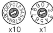
PROFIBUS 总线地址= (x10 旋钮拨码开关的值) \*10+ (x1 旋钮拨码开关的值) 例如：上图中，PROFIBUS 地址=3\*10+7=37。
