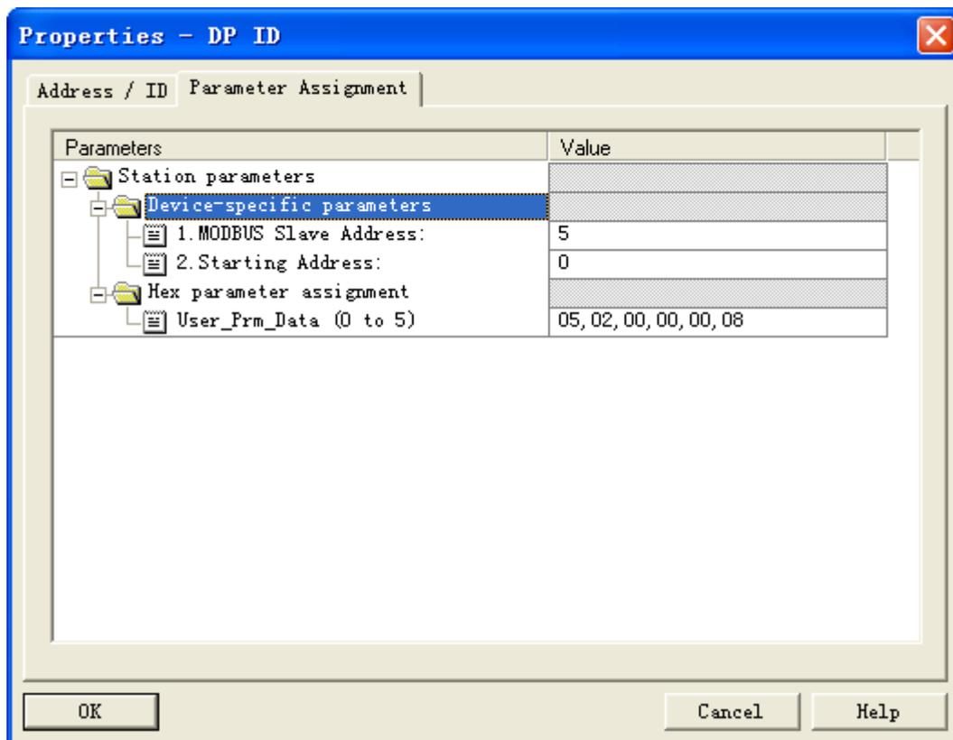
选择 Parameter Assignment，设置 Modbus 从站地址和寄存器起始地址，图中为本次测试对应前面 G0306-SS 的 MODBUS 地址（5）设置的参数，用户可根据需要配置。点击 OK，关闭配置窗口，完成配置。
