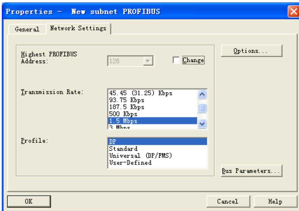
以 Modbus-DP 转换模块为例，所以配置波特率为 1.5Mbps。其它配置不变，点击“OK”，关闭总线参数配置窗口。再点击“OK”，关闭属性配置窗口。此时，“(0) UR”导轨上将会出现已选择的控制器，以及与该控制器 DP 端口相连接的一条 DP 总线。此时，硬件组态基本搭建完成，如下图所示：
