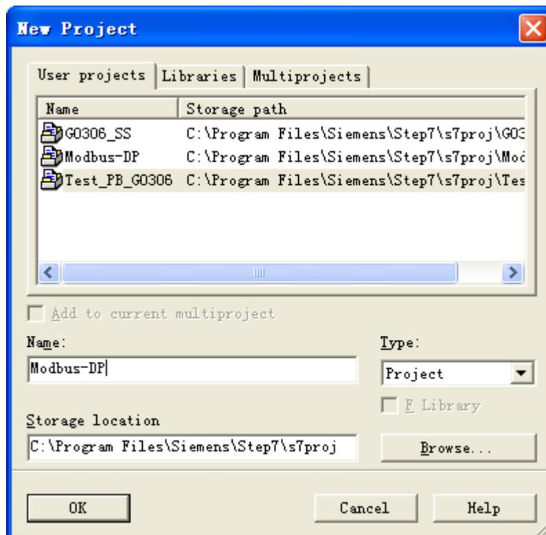
输入工程名称，例如：“Modbus-DP”；Type 缺省为“Project”；选择工程存储路径，例如：“C:\Program Files\Siemens\Step7\s7proj”，点击“OK”。然后根据实际硬件的情况来搭建工程，首先，确定 CPU 的型号。以 CPU315-2DP 为例，它是属于 SIMATIC 300 Station。所以选择“Insert→Station→SIMATIC 300 Station”。在当前工程下，将会多出“SIMATIC 300(1)”，如下图所示：
