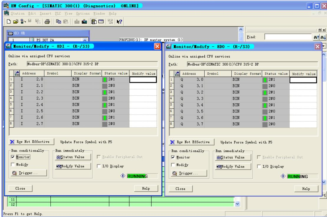
同样方法可以监视 G0306-MS 设备的 write 模块和 G0306-SS 设备中的 Input 模块数据交换情况，如下图所示：
