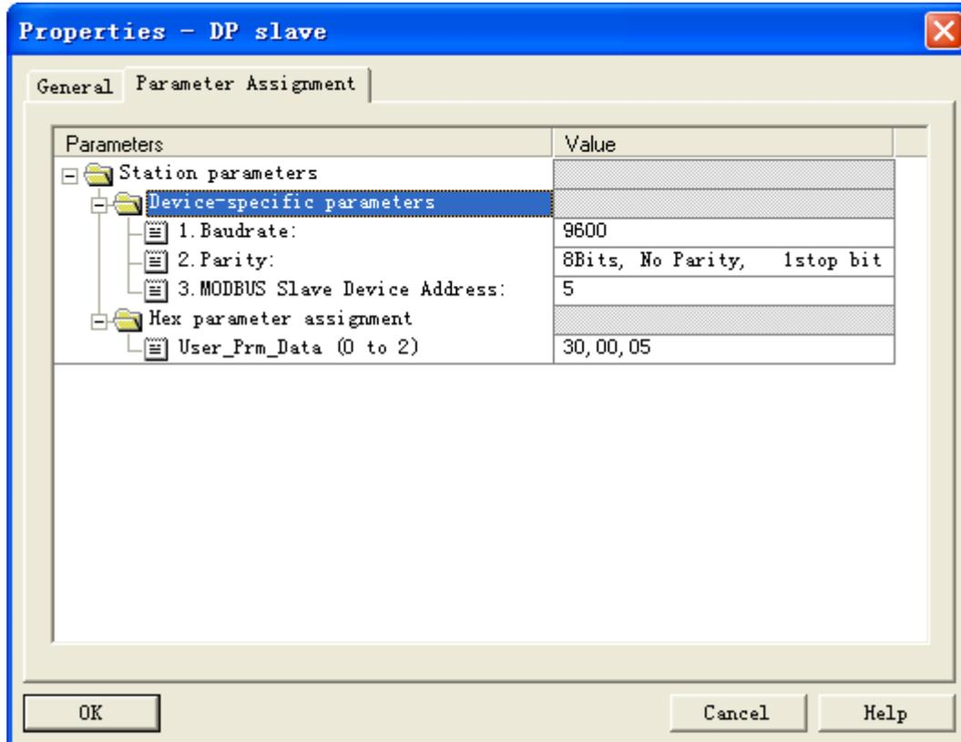
选择 Parameter Assignment 选项，设置通信参数，用户可根据实际需求进行设置，上图为根据本次测试需求，对应 G0306-MS 网关设备设置的 MODBUS 通信参数。
