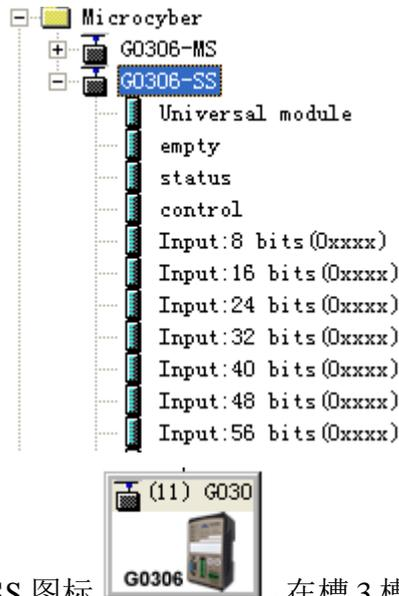
同样的方法，点击 G0306-SS 图标
