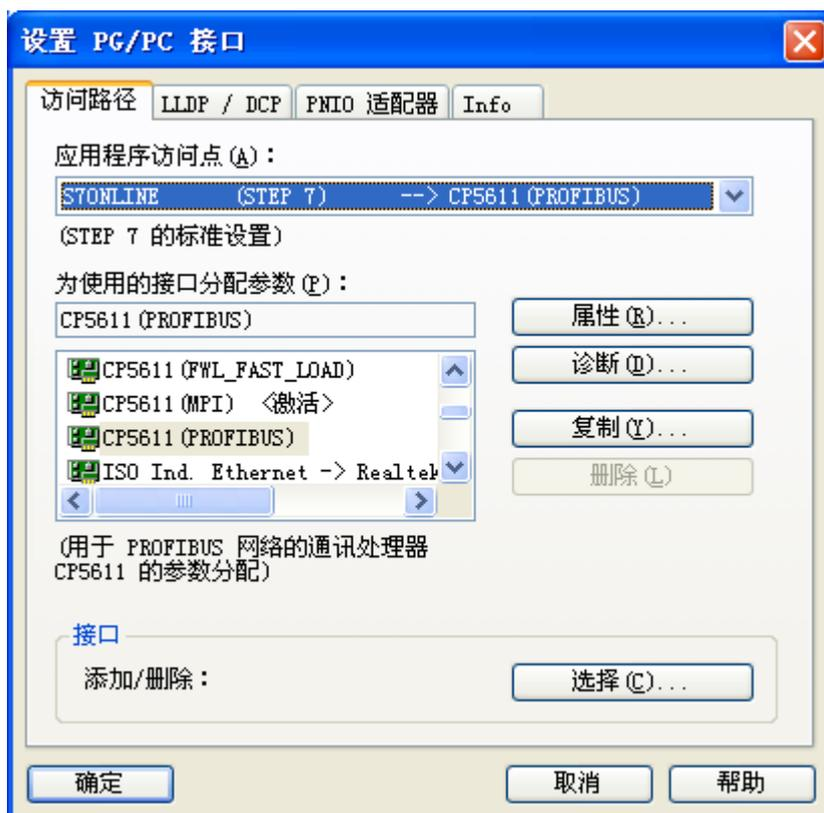
点击属性按钮，在属性窗口中，勾选“PG/PC 是总线上的唯一主站”。“传输率”的设置根据协议不同而不同，测 DP 设备，传输率设置为 1.5Mbps（DP 设备可配置多种，1.5Mbps 仅为推荐值，可根据实际工程修改，范围：9.6kbps~12Mbps，不包括 45.45kbps），配置文件选择 DP。点击确定按钮，如下图所示：
