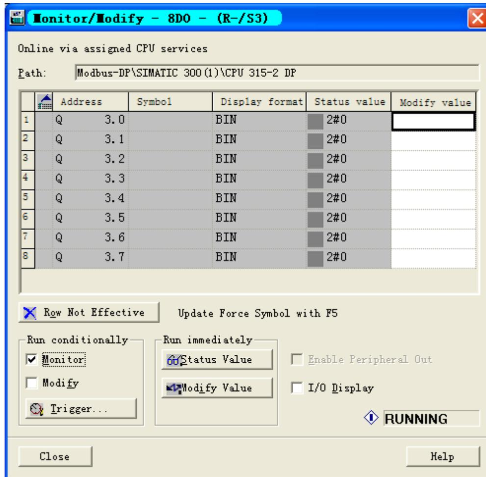
调整监视窗口的位置，设置 G0306-SS 设备中 Output 监视窗口中的输出状态值，查看 G0306-MS 设备中 read 监视窗口中对应的值状态，可以发现该值的状态与 G0306-SS 中输出值的状态信息同步变化。如下图所示：
