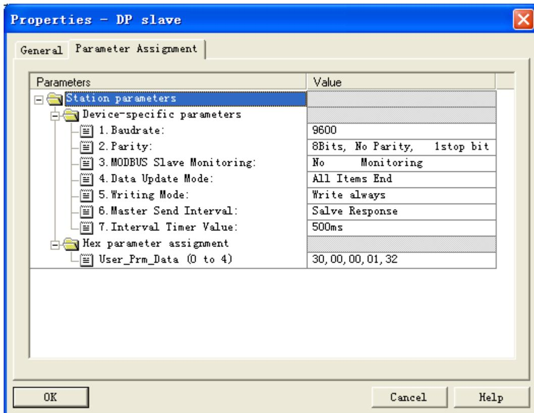
选择 Parameter Assignment 选项，设置通信参数，用户可根据实际需求进行设置，下图为举例参数：
