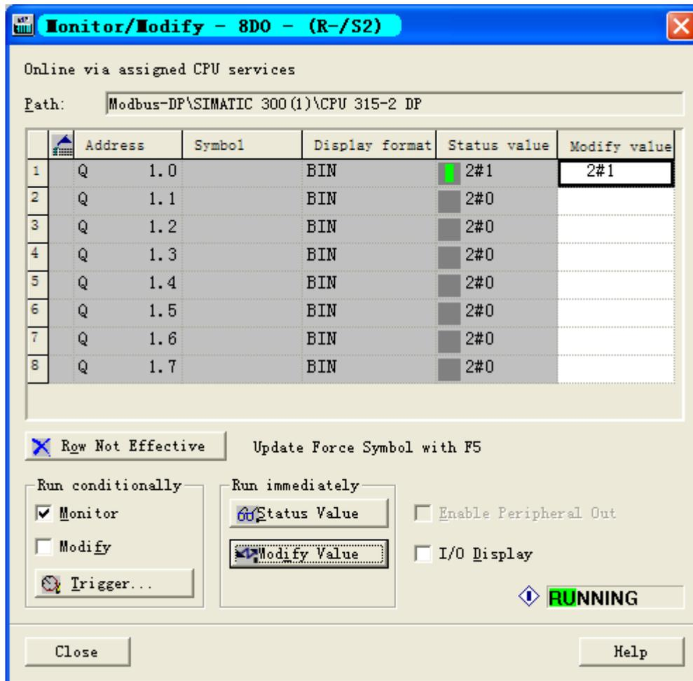
点击 Close 按钮，关闭当前监视窗口，同样方法，打开 G0306-SS 设备 Output 8 bits 模块的监视窗口，如下图所示：
