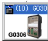
在 G0306-MS 网关设备图标上双击或者右键，选择 Object Properties,会打开网关 Modbus 属性设置窗口，如下图所示：
