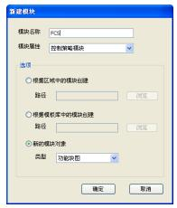
使用组态软件离线编辑的方式打开新建立的"FCS"控制模块,如下图所示:
