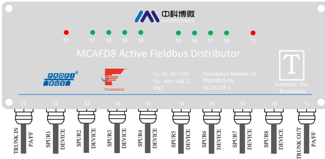
1. 通过 T1、T2 连接主线，T1 为总线输入，T2 为总线输出，通过支线 S1 到 S8 连接现场总线设备。
