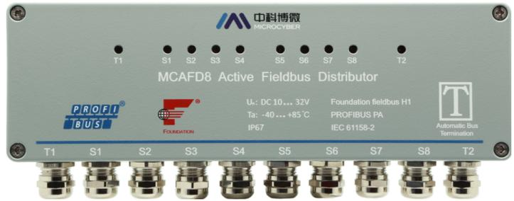
通过分配器将现场设备以主干线-分支的拓扑结构连接到系统，每个分配器有八个分支，内置自动总线终端，LED 状态指示能快速诊断主线、支线的短路状态，自动隔离故障区段，分配器的多重保护功能，保证系统安全运行。
